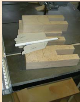
Mit der Schablone werden alle Teile gleich angezeichnet. Mit Säge, Schnitzseisen und Feile werden die Formen von außen nach innen erarbeitet. Vier ähnliche, aber nicht identische Pfoten und Köpfe entstehen.
