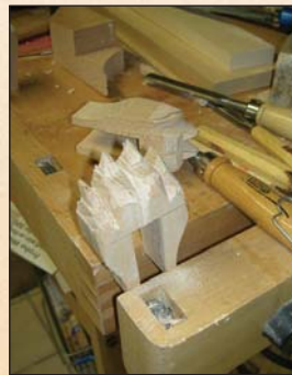
Mit der Schablone werden alle Teile gleich angezeichnet. Mit Säge, Schnitzseisen und Feile werden die Formen von außen nach innen erarbeitet. Vier ähnliche, aber nicht identische Pfoten und Köpfe entstehen.
