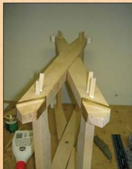
Kurz vor der Montage: Alle Teile liegen geschliffen und entstaubt bereit. Wenn der Leim trocken ist, werden die Kleide bündig abgeschnitten und verschliffen.
