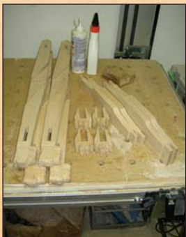
Kurz vor der Montage: Alle Teile liegen geschliffen und entstaubt bereit. Wenn der Leim trocken ist, werden die Kleide bündig abgeschnitten und verschliffen.
