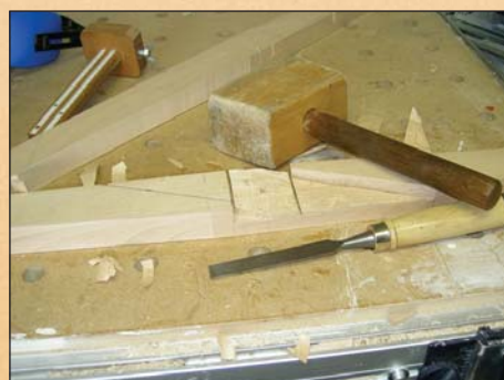
Erst werden die Flächen der Drehverbindung ausgestemmt,
