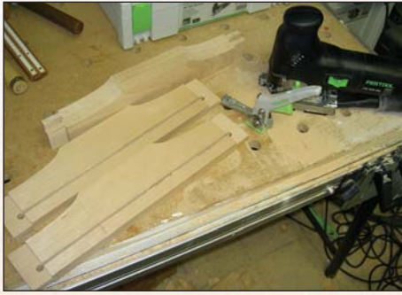
In die oberen Queren werden Schlitz für die Sitzfläche eingesägt.
