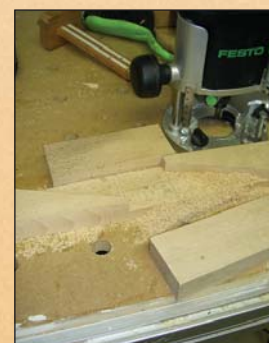
dann mit der Oberfräse geglättet.
