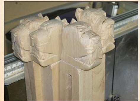
Mit der Schablone werden alle Teile gleich angezeichnet. Mit Säge, Schnitzseisen und Feile werden die Formen von außen nach innen erarbeitet. Vier ähnliche, aber nicht identische Pfoten und Köpfe entstehen.
